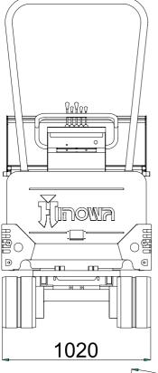
Kit caisson avec basculement hydraulique sur Hinowa minitombereau
