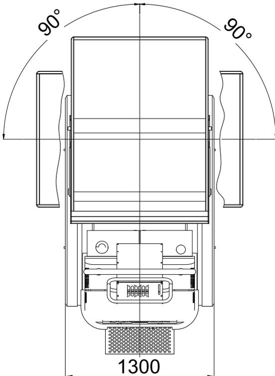
Kit caisson avec basculement hydraulique trilateral et rotation 180 ° sur Hinowa minitombereau
