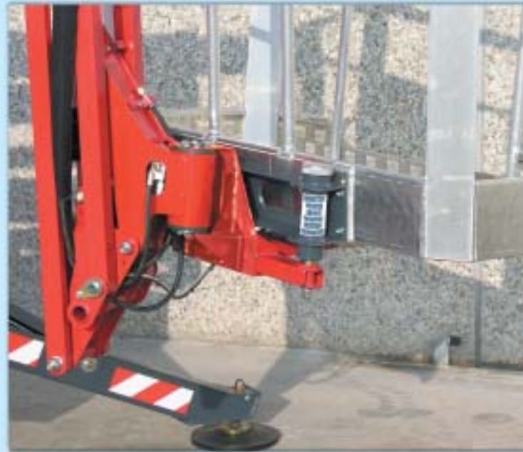
CESTO GIREVOLE (PERMETTE DI LAVORARE PERFETTAMENTE PARALLELO ALLA PARETE)
